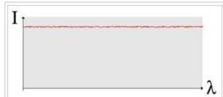
Si on analyse le même signal avec un analyseur de spectre, le bruit blanc se caractérise par un **spectre plat**.
